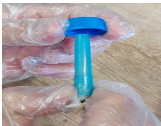
شکل ۴: متصل کردن مجموعه سرسمپلر و نمونه دندانی به دهانه لوله سانتریفیوژ.
