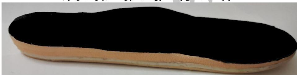
تصویر ۶: کفی سه لایه با جنس پلاستوزوت-سیلیکون-اتیلن وینیل استات
