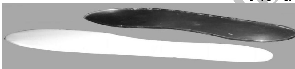
تصویر ۵: قالب کفی و سیلیکون قالب‌گیری شده برای لایه‌ی دوم
