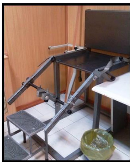
تصویر ۱: صندلی مخصوص طراحی شده برای اندازه‌گیری حداکثر گشتاور اکستانسوری زانو با سه درجه آزادی برای تنظیم درست داینامومتر
