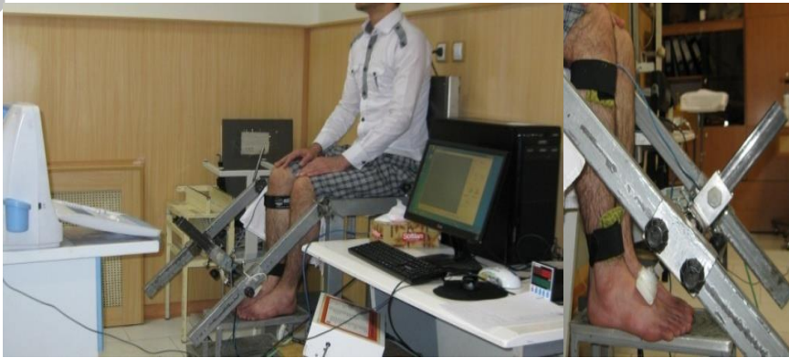
تصویر ۱: سندی و قسمت T شکل طراحی شده جهت قرارگیری لود سل به منظور انجام و ثبت عمل دورسی فلکشن میچ پا حین هر سه حالت انقباض
