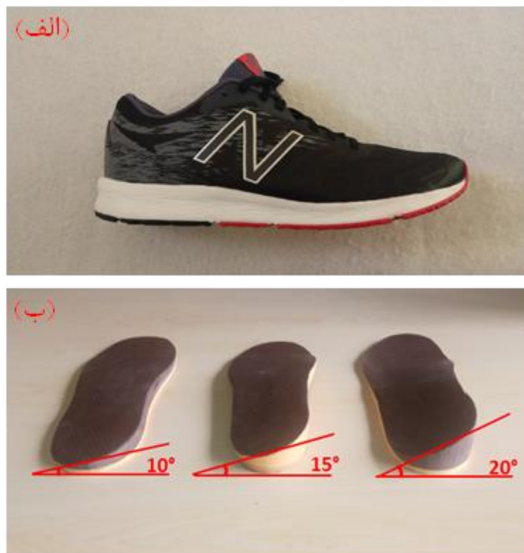
تصویر ۱: نمایی از کفش (الف) و کفی‌ها با شیب خارجی متفاوت (ب)
