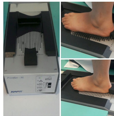
تصویر ۱. قالب‌گیری سه‌بعدی از پا برای برش کفی (چپ) و نمونه‌ای از کفی‌های طبی ساخته‌شده (راست)
