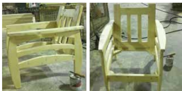
شکل ۲: کلاف (اسکلت) مبیل نمونه، ساخته شده بر اساس ابعاد به دست آمده
