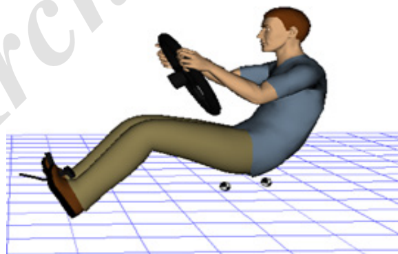
شکل ۳. اعمال پارامترهای بهینه پکیج و نحوه استقرار ارگونومیک راننده در نرم‌افزار JACK
