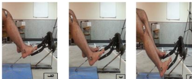
شکل ۳: چرخه پدال‌گیری، مارکرگذاری مفاصل، ثبت اطلاعات سینماتیکی و نیرو در نمای sagittal (الف) ابتدای مرحله پدال‌گیری (ب) مرحله میانی از پدال‌گیری (ج) مرحله پایانی از پدال‌گیری
