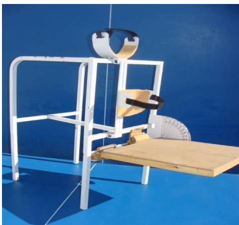
شکل ۱-۱ گونیامتر پدال دار (حرکات Plantarflexion و Dorsiflexion)
