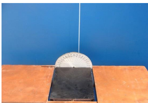
شکل ۱-۲ گونیامتر پدال دار (حرکات Inversion, Eversion)
