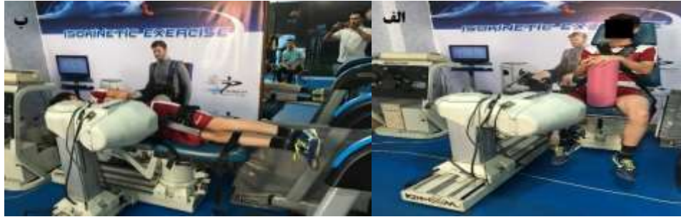
تصویر ۲: اندازه‌گیری قدرت عضلات ران (الف): چرخاننده‌های خارجی ران، (ب): دورکننده های ران
