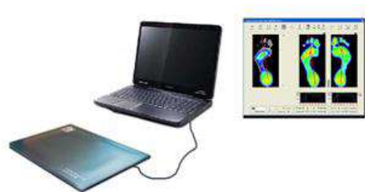
شکل ۲: دستگاه اسکن کف پا برای اندازه گیری تعادل ایستا و پویا
