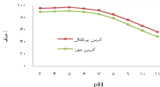
نمودار ۳. تأثیر pH بر روی کارایی حذف (دوز جاذب ۱ گرم در لیتر، غلظت ۲-کلروفنل ۲۵ میلی‌گرم در لیتر، زمان تماس ۶۰ دقیقه)
