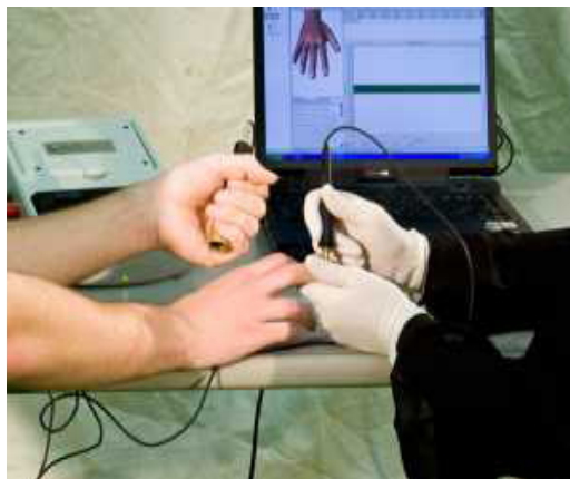
تصویر ۶- دستگاهی که فعالیت الکتریکی پوست را اندازه می‌گیرد. دستگاه دارای سنسورهایی می‌باشد که میزان تعریق بدن را اندازه‌گیری می‌نماید (۲۹).
