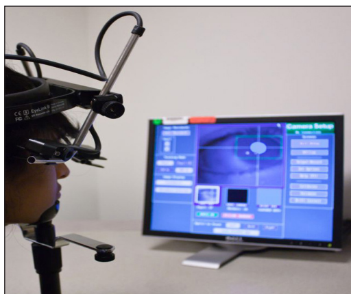
تصویر ۵- این دستگاه می‌تواند حرکات چشم را در صدم ثانیه جهت بررسی و آنالیز تغییرات چشم اندازه‌گیری نماید (۲۸).
