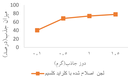
شکل ۶: تاثیر دوز های مختلف جاذب لجن اصلاح شده در حذف ۴و۲ دی نیتروفلن ( زمان بهینه ، غلظت بهینه، pH بهینه)
