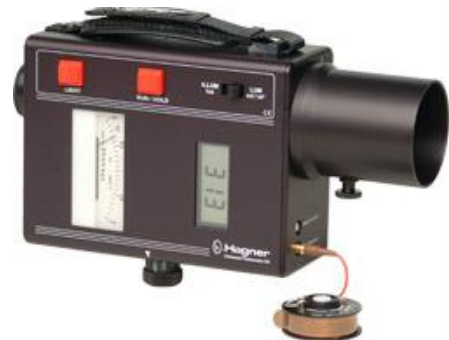
دستگاه فوتومتر هاگنر با سنسورهای نور مرئی و درخشندگی
