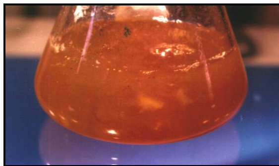
شکل 2. تولید آگزوپلیمر در محیط GMS و ایجاد حالت خمیری شکل
