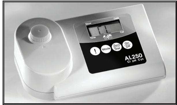
شکل ۷. تصویر دستگاه نورسنج تداخلی پلینتست مدل AL250
