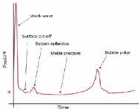
شکل ۱. نمودار توزیع فشار- زمان در پدیده انفجار زیر آب [۱۲]
