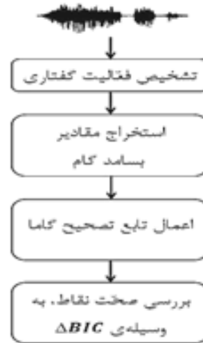
شکل ۴. فلوجارت تقطیع به روش پیشنهادی RPSS
