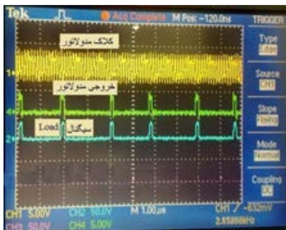
شکل ۱۰. خروجی مدولاتور DPIM به همراه سیگنال Load برای چند علامت دیگر
