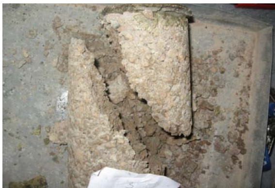
شکل ۳. یک نمونه شکسته شده با زاویه تقریباً ۴۵ درجه [۱۷]
