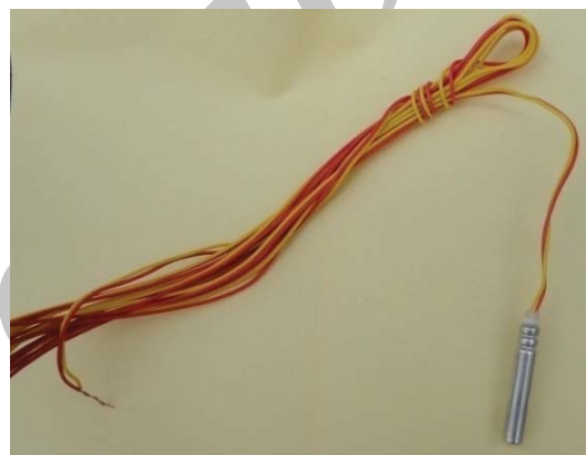
شکل ۵. تصویر چاشنی انفجاری مورد استفاده در آزمایش
