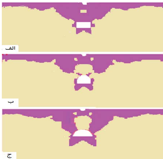
شکل ۱۶. وضعیت نواحی تسلیم شده، در محیط خاک اطراف تونل‌ها پس از انفجار. الف) تونل با مقطع مستطیلی، ب) تونل با مقطع نعل‌اسبی و ج) تونل با مقطع نیم‌دایره‌ای
