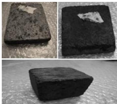
شکل ۱۶. قطعات بتنی ۱۰×۱۰ با قطرهای ۱,۲ و ۵ سانتی‌متری و ۱ درصد کربن سیاه
