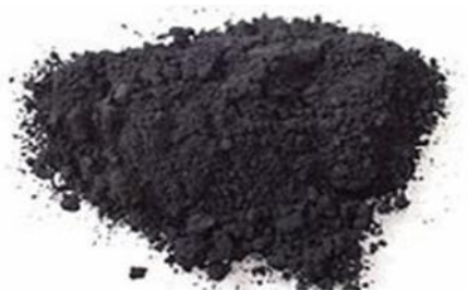
شکل ۸. کربن سیاه شماره ۵۵۰N و دانه‌های به ضخامت ۵۵-۳۹ نانومتر
