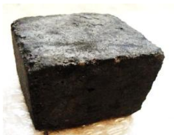
شکل ۱۱. یک قطعه بتنی 5 \times 5 \times 5 سانتی‌متری و ۵ درصد کربن سیاه مخلوط در آن
