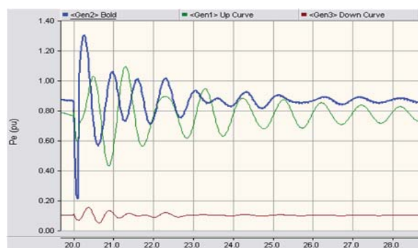
شکل ۱۳. منحنی‌های P-t برای بار پیش از خطای ۱/۵ pu و زمان رفع خطای ۰/۱ ثانیه (محور افقی برحسب ثانیه)
