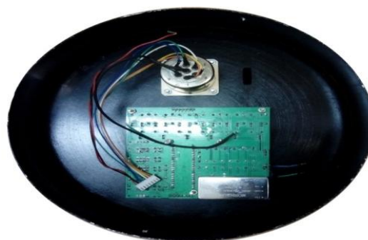
شکل ۲۵. نمای پایین آنتن هوشمند و نحوه جانمایی مدار کنترلی در آنتن هوشمند
