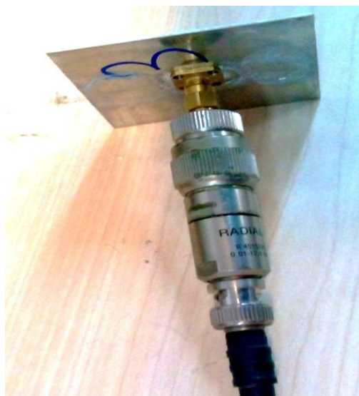
شکل ۱۲. نمای وجه کناری آنتن پچ به همراه نحوه اتصال کانکتور
