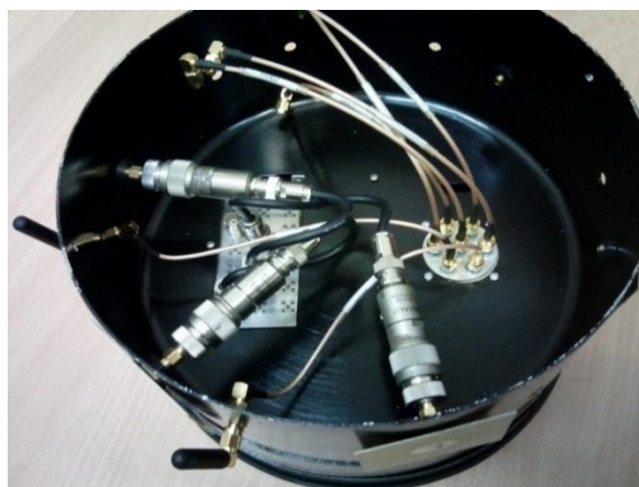
شکل ۱۸. نمایی از جانمایی آنتن Rubber duck به همراه کل ساختار
