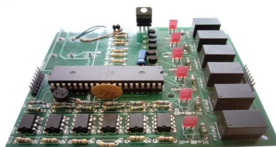
شکل ۲۳. نمای جلوی مدار کنترلی آنتن هوشمند
