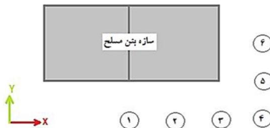
شکل ۸. موقعیت‌های محتمل وقوع انفجارها نسبت به سازه
