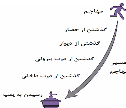
شکل ۳. مسیر تهاجم برای نابود کردن یک پمپ حیاتی در تأسیسات آب و فاضلاب
