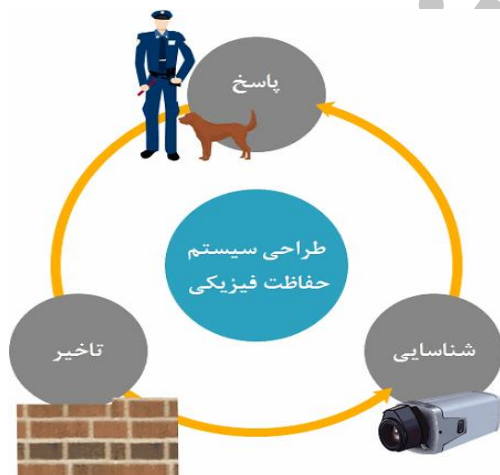
شکل ۲. طراحی سامانه حفاظت فیزیکی
