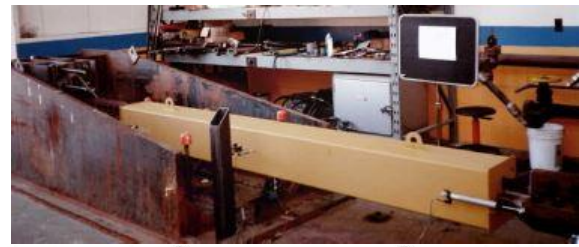
شکل ۲. مدل آزمایشگاهی و نمای مهاربند کمانش‌ناپذیر مورد مطالعه [۲۰]
