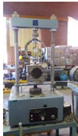
شکل ۴. انجام آزمایش مقاومت مارشال بر روی نمونه‌ها
