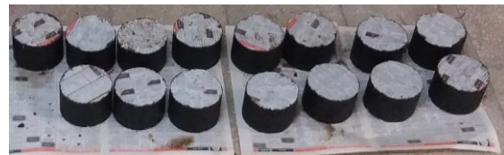
شکل ۳. نمونه‌های آسفالتی تهیه‌شده توسط دستگاه ژیراتوری
