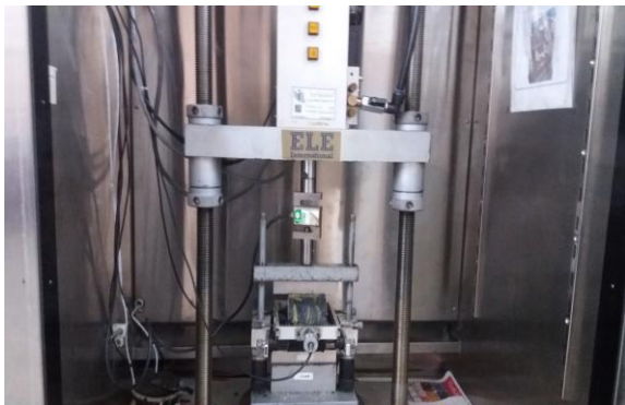
شکل ۵. انجام آزمایش مدول برجهندگی بر روی نمونه‌ها
