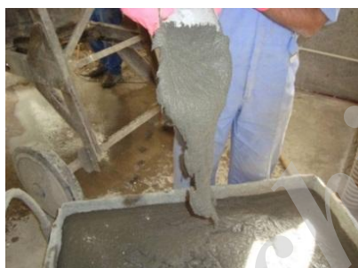
شکل ۱. مخلوط بتن فوق توانمند الیافی
