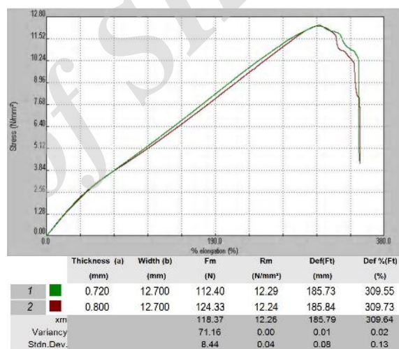
شکل ۴. نتایج آزمون پارگی مربوط به نمونه سنتزی PUU-۱۳۲
