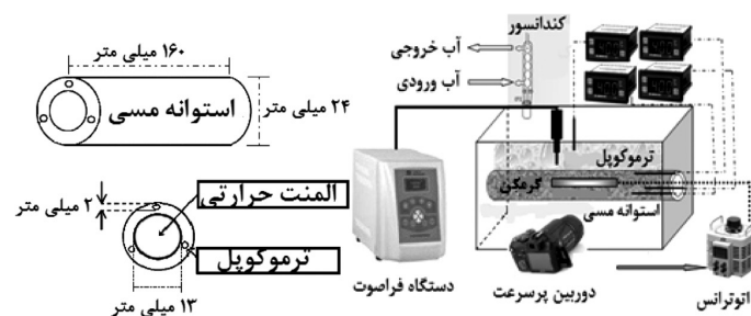
شکل ۱ الف) شماتیک دستگاه آزمایشگاهی و ب) المننت گرمایشی
