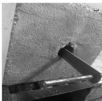
شکل ۲ تهیه نمونه شکافدار: الف) شکاف از پیش موجود و ب) روند ایجاد شکاف
