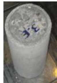
شکل ۱۴: هسته بتنی دورپیچی شده با غلاف SIFCON.
