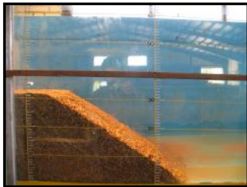
شکل ۱۰: تصویر پیشروی زبانۀ رسوبی در فلوم (دید از سمت جدارۀ شیشه‌ای).
