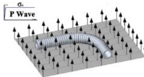
شکل ۱۰: تونل خمیده تحت اثر گسترش موج پله ای فشاری.
