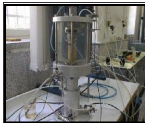
شکل ۴: دستگاه سه‌محوری مسیر تنش بیشاپ-وسلی.
