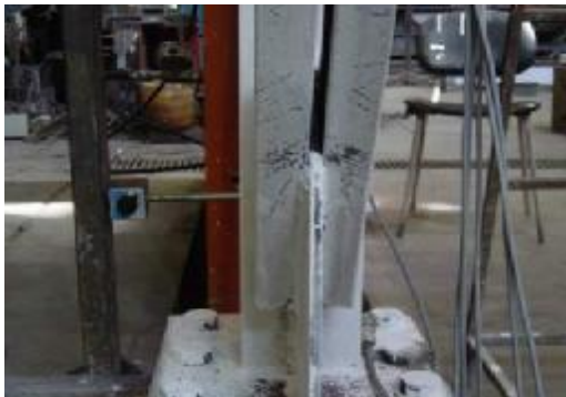
شکل ۱۰: جاری شدن موضعی مهاربندها به دلیل به وجود آمدن لنگر خمشی در انتهای آنها.
