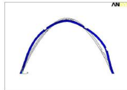
شکل ۵: تغییر شکل نمونه ترک خورده در مود دوم.
