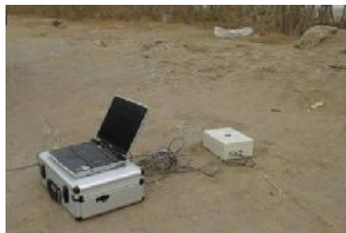
شکل ۲: دستگاه ثبت میکروترومور به همراه سایر تجهیزات.
