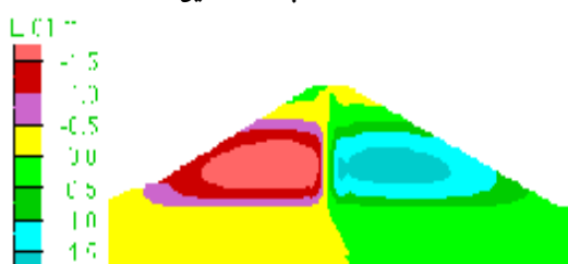
شکل ۵-ب: کنتورهای تغییر مکان افقی در پایان ساخت - سد با هسته قائم.
