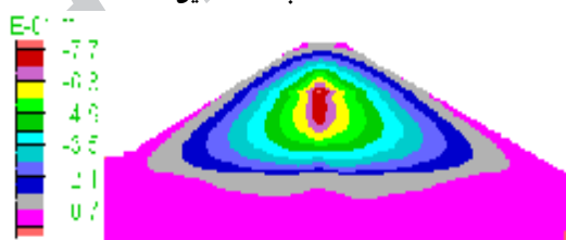
شکل ۴-ب: کنتورهای تنش در پایان ساخت - سد با هسته قائم.
