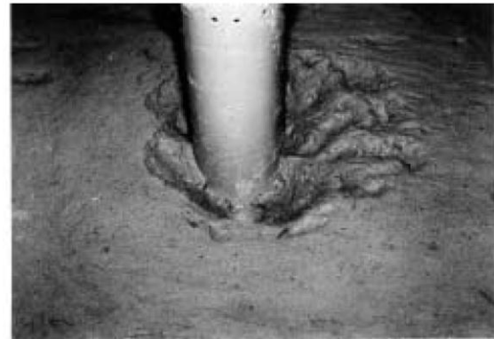
شکل ۷: نحوه شکل‌گیری آبستنگی اطراف پایه در آزمایشگاه با توجه به جنس بستر، بالا: بستر ماسه ای ( PI = 0 ) و پایین: بستر رسی ( PI = 20\% ) [۹]
