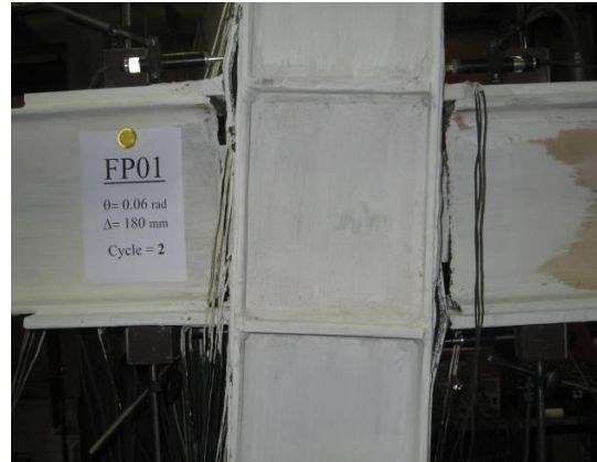
شکل 18: تغییر شکل بیش از حد صفحه روپوش ستون در مدل آزمایشگاهی اتصال متداول [13]
