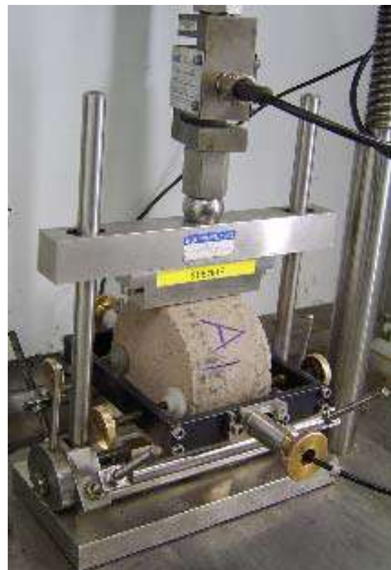
شکل ۴: دستگاه آزمایش مدول برجهندگی
