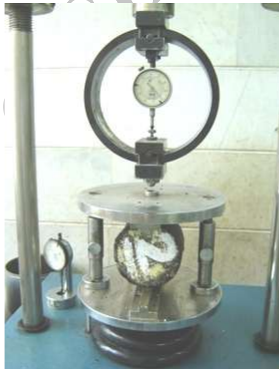
شکل ۵: دستگاه آزمایش مقاومت کششی غیرمستقیم
