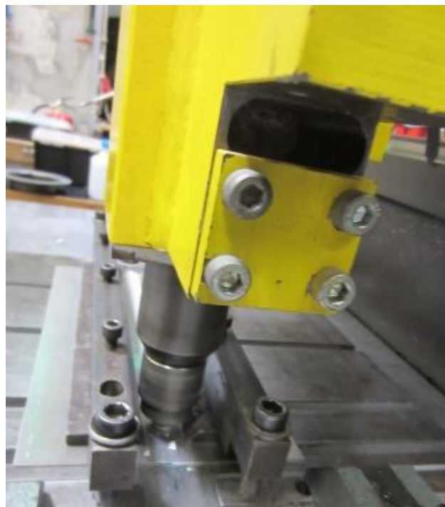
شکل ۲: دستگاه جوشکاری اصطکاکی مورد استفاده در آزمایش های تجربی
