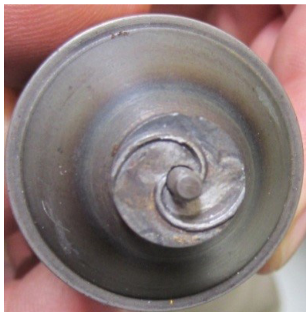
شکل ۴: هندسه ابزار مارپیچ مورد استفاده برای جوشکاری
