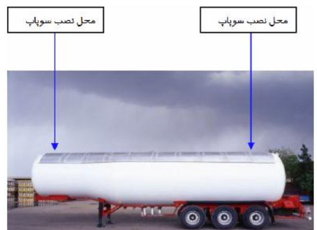
شکل ۲: محل‌های نصب سوپاپ بر روی مخزن
