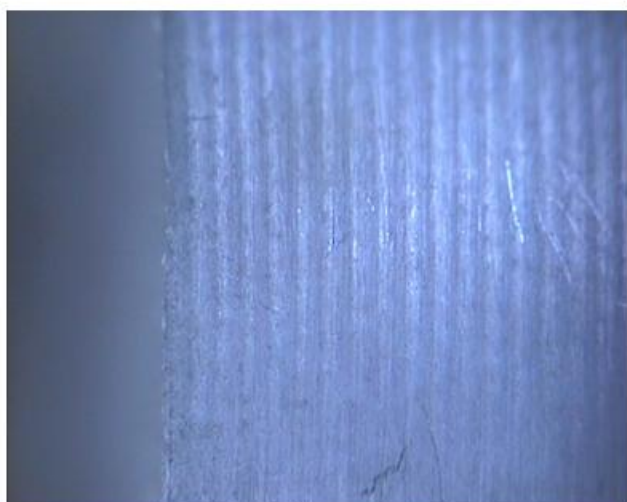
شکل ۱۲: تصویر استریو میکروسکوپ از ریز ترک های موجود در سطح
