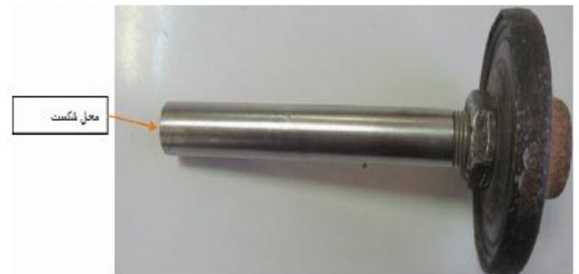
شکل ۱: محل شکست در سوپاپ شکسته شده
