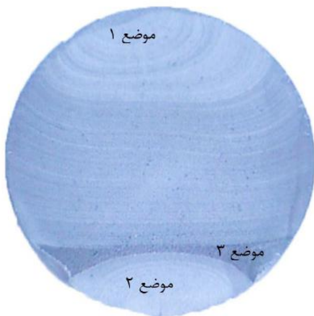
شکل ۱۱: تصویر استریو میکروسکوپ از مقطع شکست
