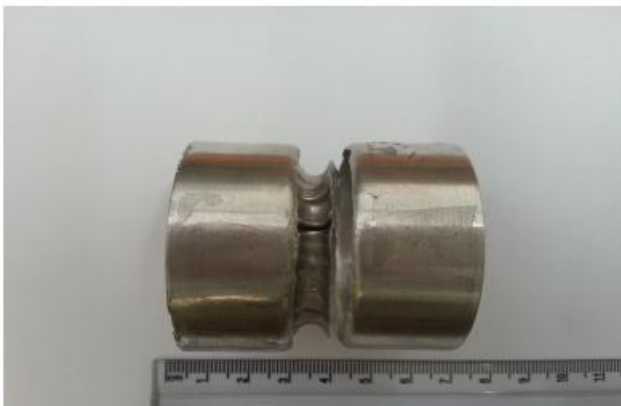
شکل ۱۵: لوله شکل‌دهی شده در آزمون تجربی برای v=6200V, t=0/6 mm, c=0/1 mm
