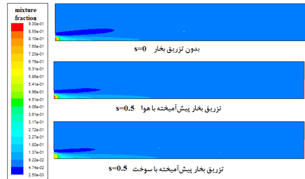
شکل ۹: کانتور کسر مخلوط در محفظه احتراق برای سه حالت بدون تزریق بخار، تزریق بخار پیش‌آمیخته با هوا و تزریق بخار پیش‌آمیخته با سوخت
